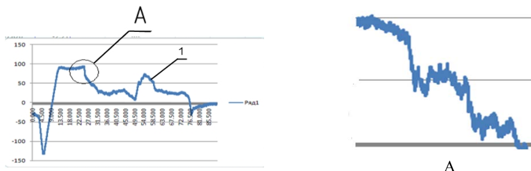
Рис. 1. Профиль образующей поверхности среза круглой детали \varnothing 20,8 мм толщиной 5 мм
